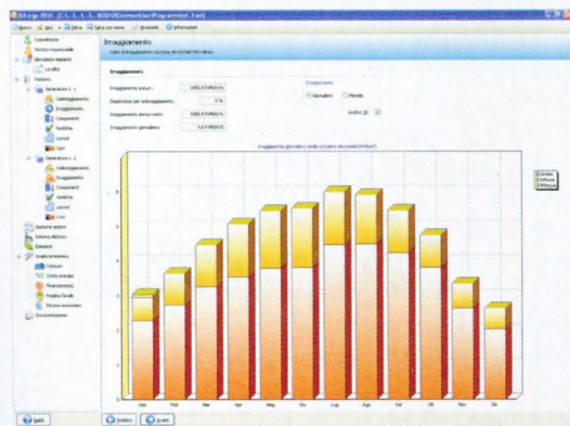
▲ Die Einstrahlungsleistung wird nach direkten, indirekten und reflektierten Anteilen aufgeteilt
